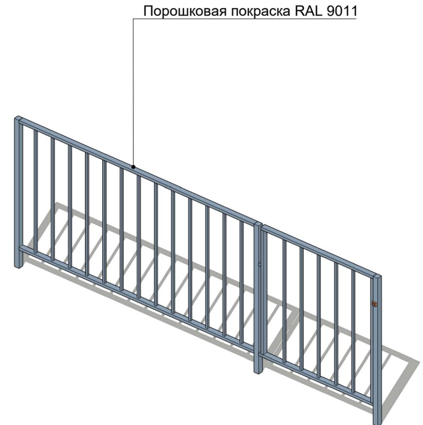
Ограждение площадки автостоянки - вертикальные опорные столбы из металлического профиля 40x40 и сварная металлоконструкция, состоящая из 2-х стальных вертикальных профилей 20x40 с приваренными 13-тью вертикальными профилями 15x15. Секция калитки состоит из вертикальных опорных профилей 40x40 и подвижной секции из металлического профиля 20x40: 2-х вертикальных и 2-х горизонтальных - 2 петельных элемента, магнитный замок. Порошковая покраска RAL 9011.
